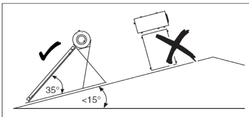
As estruturas foram concebidas exclusivamente para a fixação segura dos coletores e do acumulador. O ângulo de inclinação do coletor é de 35°.
